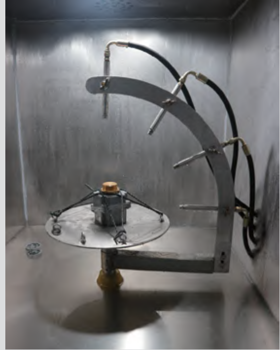
Boitier en cours d'essai IPx9K
